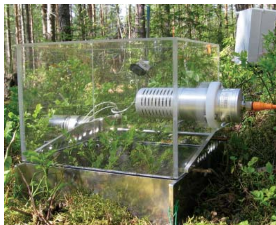
Kuva 8: Kaasuvaihdon mittauksiin suunniteltu automaattikammio Hyytiälän SMEAR II -asemalla (Juu-pajoki). Kammio on automaattisesti sulkeutunut, jolloin kammion ilmasta mitataan kaasujen pitoisuuden muuttumista. Muutoksista lasketaan esimerkiksi hiilidioksidin tai metaanin vuo eli maaperän/turpeen vapauttama tai sitoma aineen määrä. Kuva: Liisa Kulmala.
