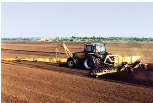
Kuva 12: Kunnostettua avoturvesuota jyrjitään. Kuva: VTT/Aho.
